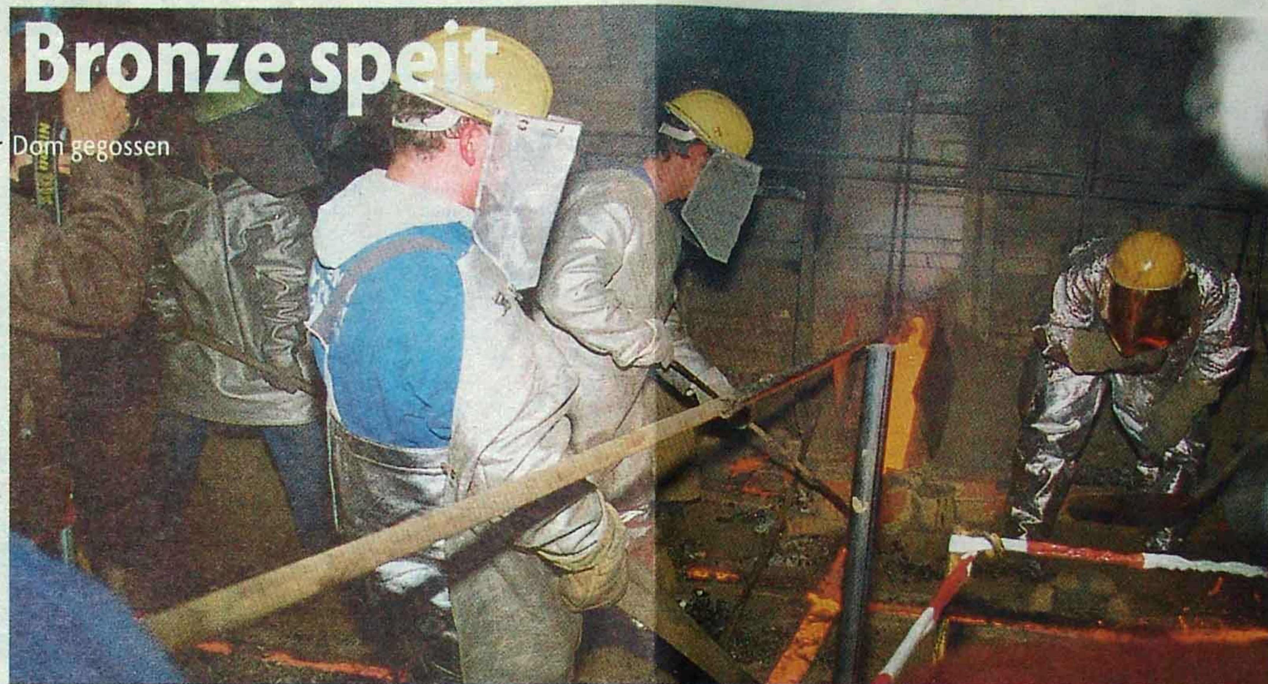
Mit einer Hitze von über 1.000 Grad schießt die flüssige »Glockenspeise« aus Kupfer und Zinn aus dem mit Holz und Kohle beheizten Glutofen.
